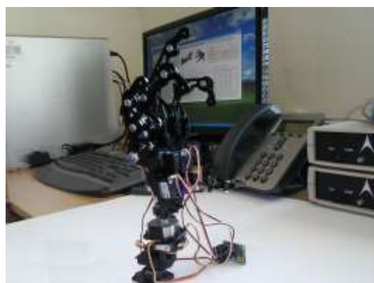
Obr. 7 a 8 Prepojenie robotickej ruky a zápästia
