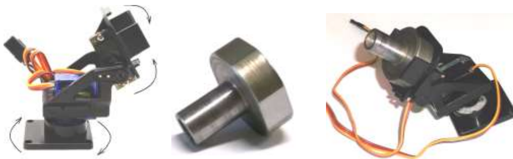
Obr. 6 Dvojpolohové servo a spojovacia príruha použité ako zápästie robotickej ruky
